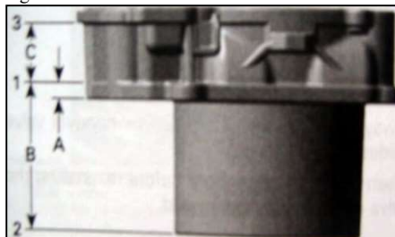
1. Prima misurazione del diametro 2. Seconda misurazione del diametro 3. Terza misurazione del diametro Un. 7 mm dal fondo del cilindro B. 68mm C. 32mm
